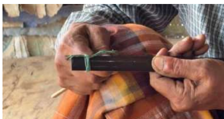
Gambar 14. Menggosok Jarak Elak-elak Menggunakan Gosokan
